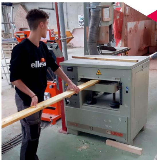
Rabotage du bois dans le cadre de la création de la charpente, réalisé par les jeunes en CAP de la section menuiserie
